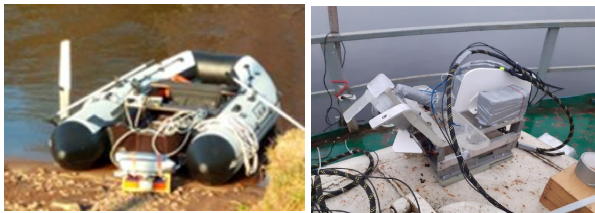
Рисунок 7.3 – Средства подводной фотовидеосъемки: слева – надувная лодка «RiverBoat» с аппаратом «Limnoscout-230» у кормы, справа – аппарат «Limnoscout-50+»
