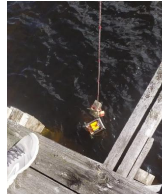
Рисунок 7.6 – Узлы и запуск устройства беспроводной передачи видеоданных со дна
