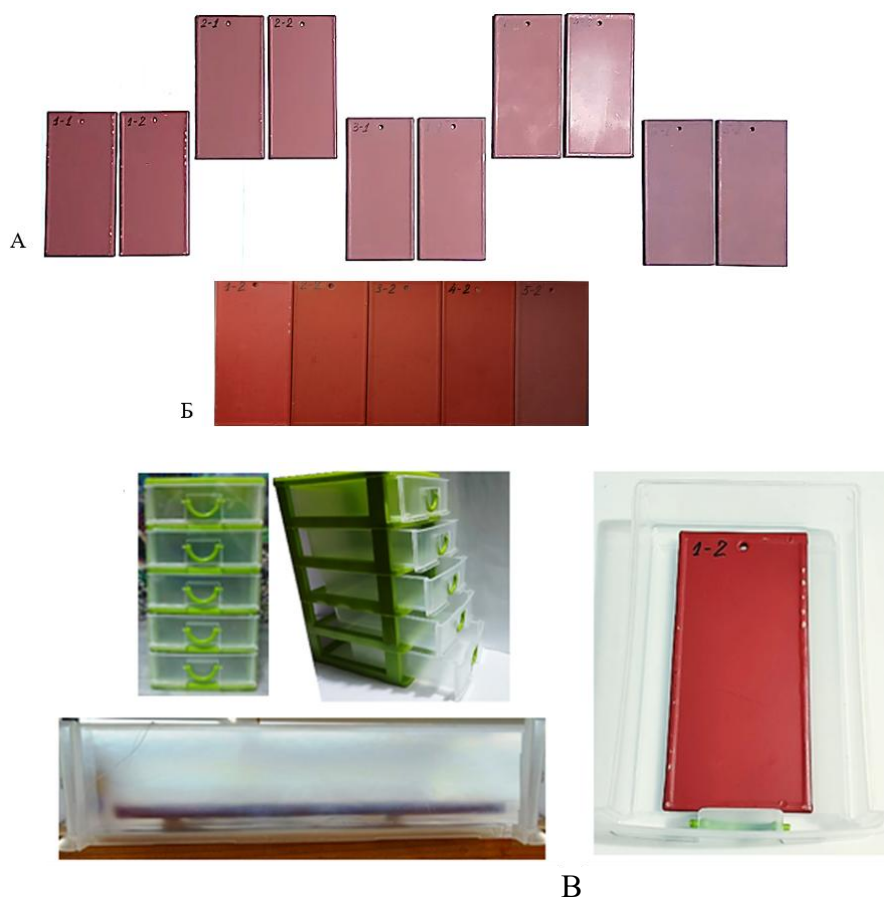
Рисунок 6.14 – А-образцы 5-ти видов лакокрасочных покрытий производства компании ООО НПП «ВМП-Нева», посредством помещения которых в экспериментальные емкости, заполненные водой были сформированы среды (1-2), (2-2), (2-3), (2-4) и (2-5); Б-цветовая гамма ЛКП; В-конструкция опытной этажерки с открытыми одноразовыми контейнерами – емкостями для проведения краткосрочного острого отборочного эксперимента для установления эффекта образца на организмы - мишени и непрофильные организмы, находящиеся в контейнерах в естественной воде водоема-охладителя; образец в контейнере виды сбоку и сверху.
