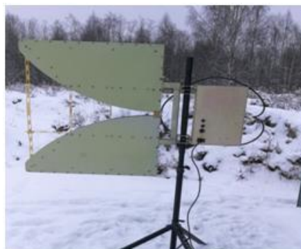
Рис. 26. Генератор наносекундных импульсов со сверхширокополосной антенной: амплитуда 50 кВ, длительность фронта 0.4 нс, ширина импульса 1 нс, частота повторения до 1 кГц
