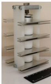
Рис. 25. Коммутатор наносекундных импульсов на основе ударно-ионизационных динисторов: рабочее напряжение 24 кВ, ток в импульсе 5 кА, длительность импульса 200 нс, рабочая частота 100 Гц
