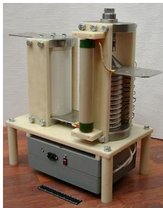
Рис. 23. Коммутатор микросекундных импульсов на основе разработанного в ФТИ рекордно-мощного импульсного полупроводникового ключа микросекундного диапазона – реверсивно-включаемого динистора: рабочее напряжение 24 кВ, ток в импульсе 300 кА, длительность импульса 300 мкс
