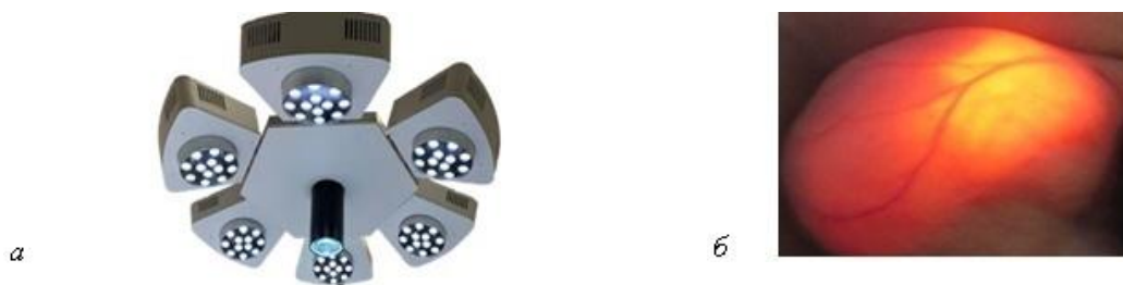
Рис. 8. Светодиодный хирургический осветитель для контрастной визуализации биологических тканей: (а)– общий вид, (б) – контрастная визуализация кровеносных сосудов на фоне мышечной ткани
