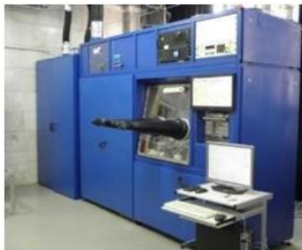
Рис. 1. Установка ГФЭ МОС для опытного производства III-N гетероструктур
