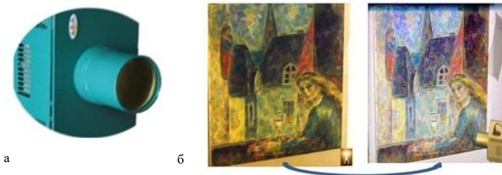
Рис. 6. Светодиодный управляемый осветитель для музейного освещения: (а) – фотография, (б)– сравнительный вид живописи при освещении лампой накаливания и ИИС с оптимально подобранным спектром
